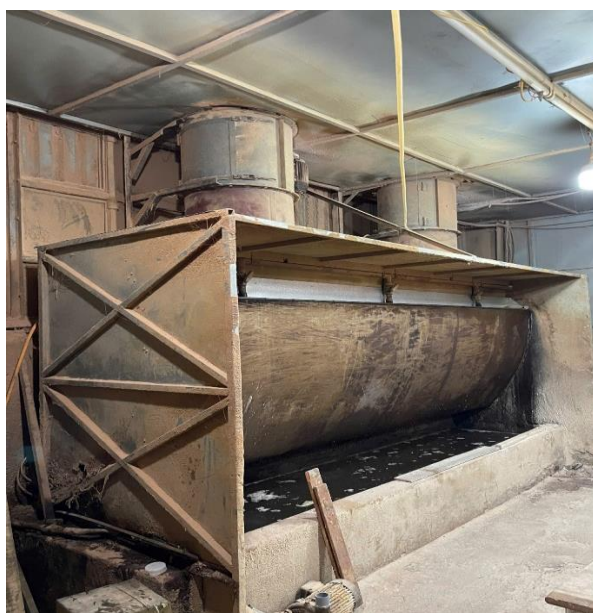
Hình 13. Hình ảnh hệ thống xử lý hơi dung môi bằng màng nước
