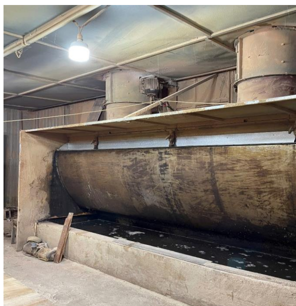
Hình 13. Hình ảnh hệ thống xử lý hơi dung môi bằng màng nước
